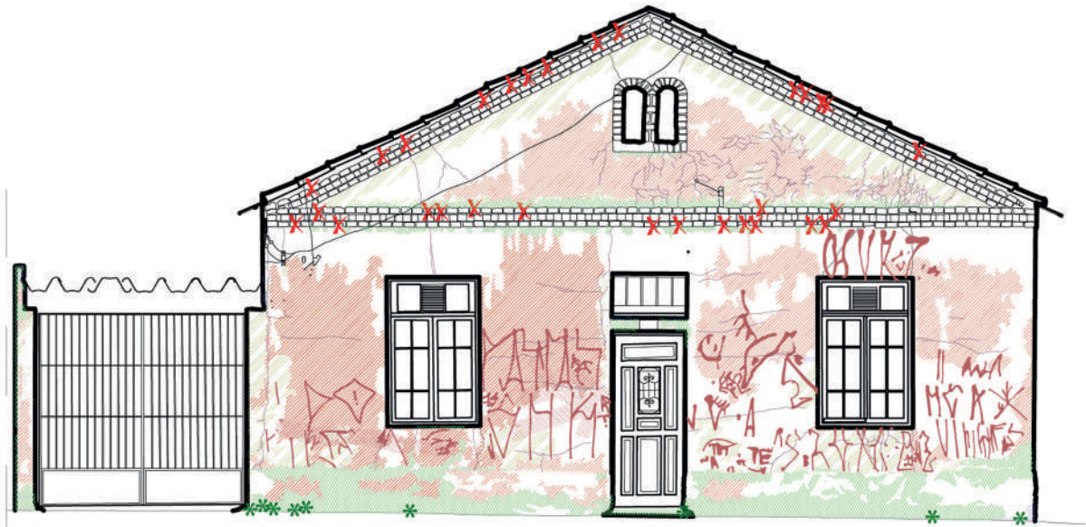
MAPEAMENTO DE DANOS | VISTA 1
